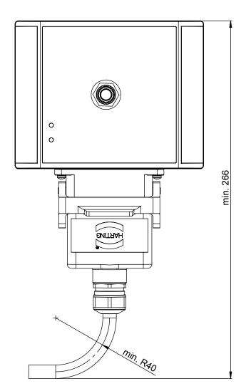
Maße für die Befestigung des Empfängers (Befestigungsbohrungen unterhalb der beiden seitlichen grauen Blenden)
